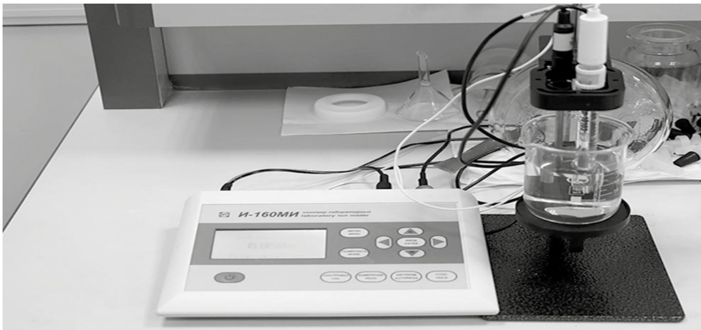
Рис.1. Ионометр лабораторный И-160 МИ
