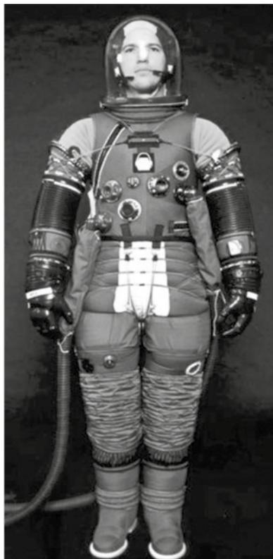
Между двумя типами конструкций возможен компромисс: современные костюмы сочетают в себе вращающийся подшипник и спиральные соединения, что обеспечивает хорошую мобильность, комфорт и достаточную массу. Нынешний EMU США является хорошим примером гибридного скафандра такого типа. Эта система включает в себя скафандр в сборе, элементы защиты и комфорта, а также систему жизнеобеспечения.
